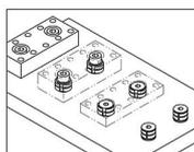
Для обеспечения точной стабильности повторяемости заготовка должна позиционироваться устройством для позиционирования.
