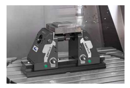
5-координатная обработка на 5-осевом фрезерном станке.
