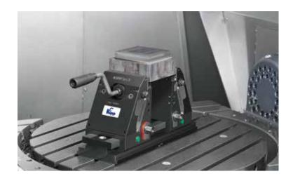
Прижим с помощью KIPPflexX с функцией центрального зажима. Оба зажимных кулачка закрыты, поэтому при распределении силы — за счет перегиба прилегающего зажимного кулачка — создается ход вниз на опору заготовки.
