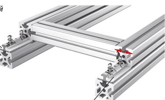
Плавающий подшипник с винтами M5.
