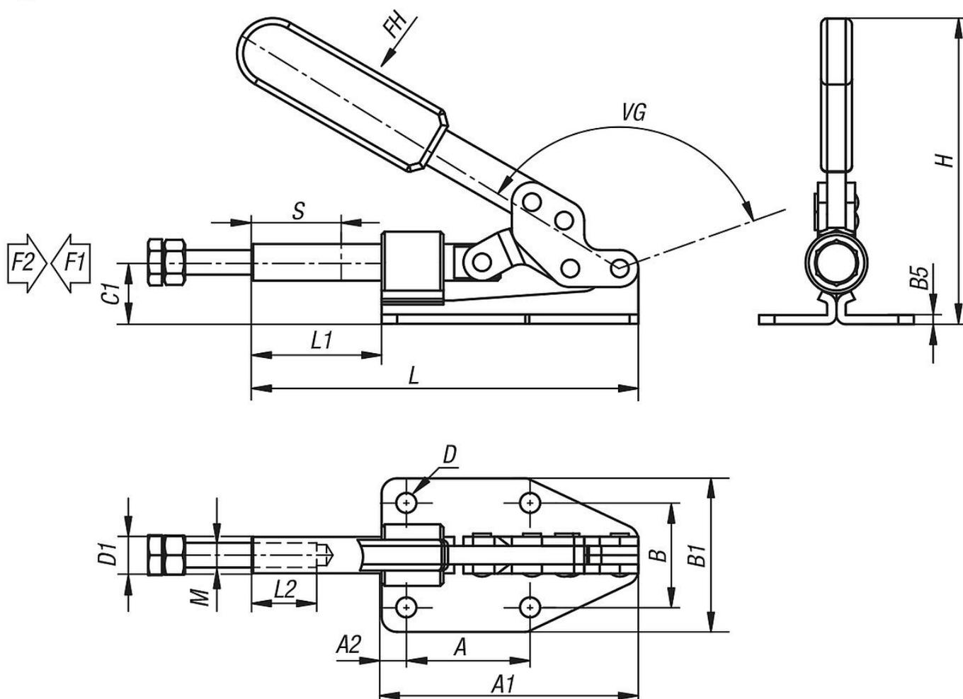
Прижимное устройство с толкающей штангой, сталь, сила зажима до 3575 Н, форма А
