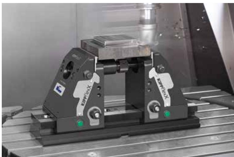
5-координатная обработка на 5-осевом фрезерном станке.
